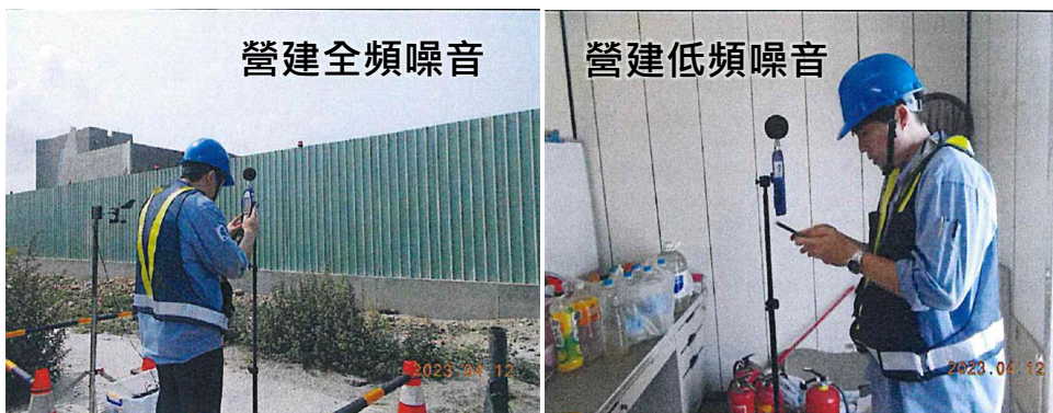
營建噪音現場監測情形
