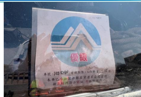
開挖機具(挖土機)比照柴 油車三期以上排放標準
